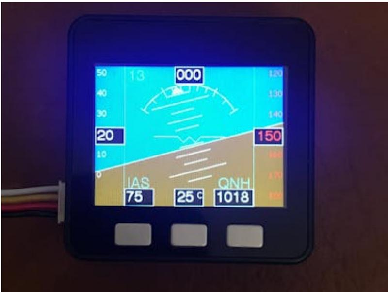
[M5stack basiertes PFD \(Primary Flight Display\)](#)
