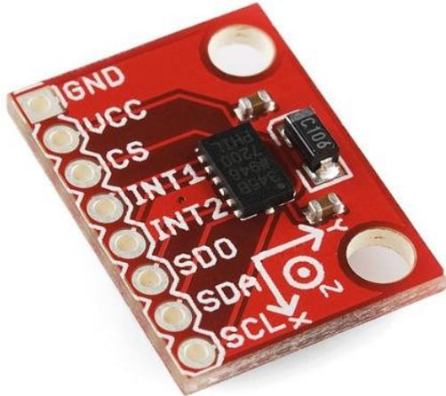
Diese neue Version verfügt über zwei Standoff-Löcher und einen zusätzlichen Entkopplungskondensator. Der ADXL345 ist ein kleiner, dünner, stromsparender 3-Achsen-MEMS-Beschleunigungssensor mit hoher Auflösung (13 Bit) bei bis zu  $\pm 16$  g. Die digitalen Ausgangsdaten werden als 16-Bit-Zweierkomplement formatiert und sind entweder über eine SPI- (3- oder 4-Draht) oder eine I2C-Digitalschnittstelle zugänglich.
