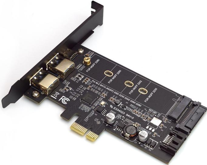
Diese PCI Express Karte erweitert den PC um einen USB Type C 3.1 Anschluss, zwei USB 3.0 Typ A Anschlüsse, einen internen SATA Anschluss sowie einen Steckplatz für M.2 Karten.
