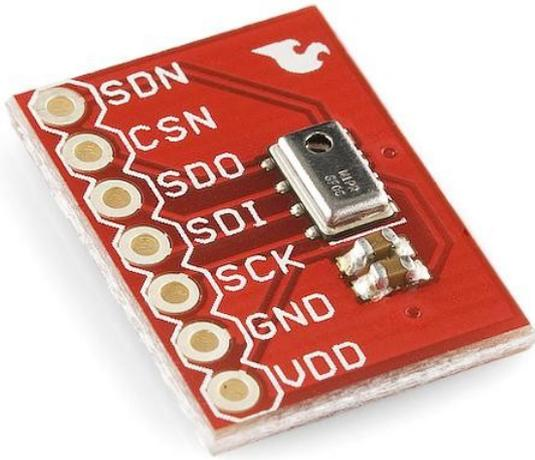
Das MPL115A1 ist ein digitales Barometer, das auf einem Breakout-Board montiert ist. Es nutzt MEMs-Technologie, um genaue Druckmessungen zwischen 50kPa und 115kPa zu liefern. Wir führen die SPI-Interface-Version des Sensors. Die durchschnittliche Stromaufnahme beträgt 10 $\mu$ A bei einer Messung pro Sekunde.
