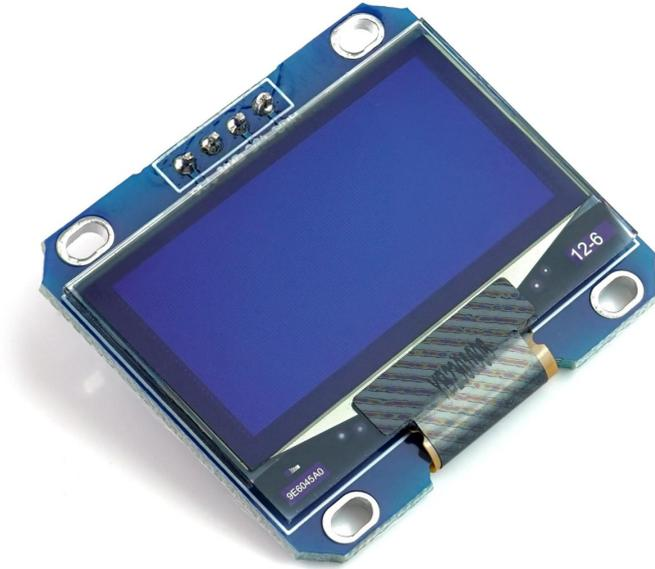
Dieses Display bietet dank der OLED Technologie, eine kontrastreiche und scharfe Darstellung von Inhalten. Das Display verfügt über eine Auflösung von 128 x 64 Pixeln. Dank der I2C Schnittstelle lässt sich das Display mit lediglich 4 Pins mit einem Arduino, Raspberry Pi oder anderen Mikrocontrollerboards verbinden.
