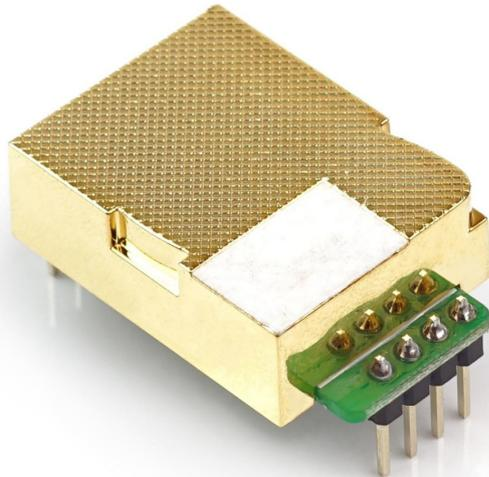
Das MH-Z19C Infrarot-Gasmodul ist ein kleiner Sensor, der das nichtdispersive Infrarot (NDIR) Prinzip verwendet, um die Existenz von CO<sub>2</sub> in der Luft zu erfassen. Der Sensor zeichnet sich durch gute Selektivität ab und arbeitet sauerstoffunabhängig. Er besitzt eine eingebaute Temperaturkompensation und gibt die Daten über einen UART oder PWM Ausgang aus.
