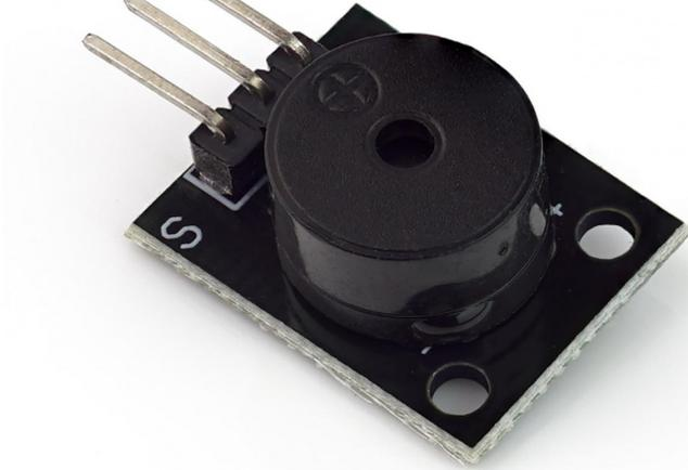
Mit PWM-Signalen verschiedener Frequenzen angesteuert, können mit dem passiven Piezo-Buzzer verschiedene Töne erzeugt werden.
