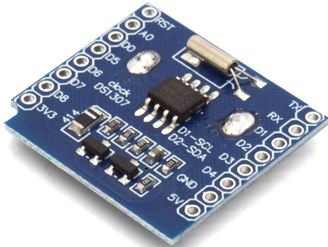
Mit dem RTC Shield lässt sich der D1 Mini um Echtzeituhr erweitern.
