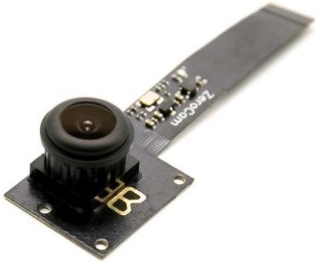
Diese Raspberry Pi-Kamera verfügt über ein breites 160° Fisheye-Objektiv und verwendet den gleichen OV5647-Chip wie die Standard Raspberry Pi-Kamera (Version 1)! Sie ist daher in der Lage, ein kristallklares Bild mit 5 MP Auflösung oder eine 1080p HD-Videoaufnahme mit 30 Bildern pro Sekunde zu liefern.
