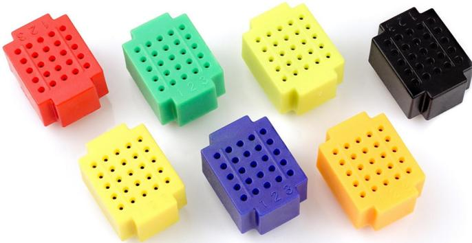
Diese Super Mini Breadboards erlauben es schnell einfache, fliegende Schaltungen aufzubauen.
