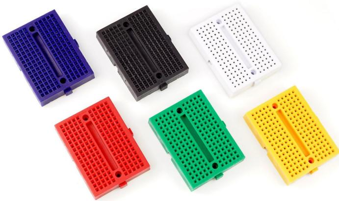
Dieses Mini Breadboard erlaubt es schnell einfache, fliegende Schaltungen aufzubauen. Mehrere Steckboards, auch in verschiedenen Farben, können problemlos zusammengesteckt werden.
