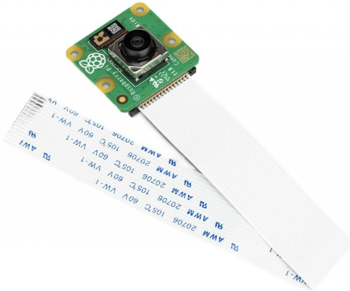
Das Raspberry Pi Camera Module 3 ist eine kompakte Kamera von Raspberry Pi. Sie bietet einen IMX708 12-Megapixel-Sensor mit HDR und verfügt über einen Autofokus mit Phasenerkennung. Das Kameramodul 3 ist in einer Standard- und einer Weitwinkelvariante erhältlich, die beide mit oder ohne Infrarotsperfilter erhältlich sind.
