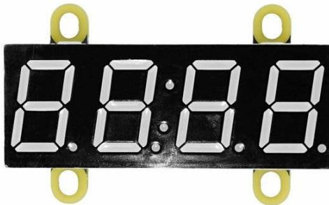
Die **UNIT-Digi-Clock** ist ein 2,1 Zoll großes 4-stelliges 7-Segment-Anzeigemodul. Jede Ziffer hat einen Dezimalpunkt und eine zusätzliche Leitung für Doppelpunkte in der Mitte, die Dezimalzahlen und die Uhrzeit anzeigen kann. Dieses Modul verwendet den TM1637 als Treiber-IC und den STM32F030 für die I2C-Kommunikation. Die I2C-Adresse kann per 4-Bit-Dip-Schalter geändert werden. Die rote LED unterstützt 8 Helligkeitsstufen. Und wir haben 4 Befestigungslöcher vorgesehen.
