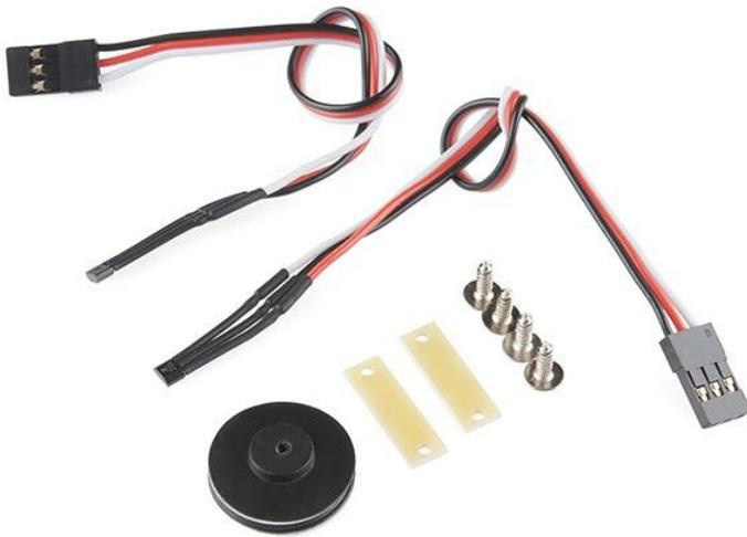
Dies ist das Wheel Encoder Kit von DAGU, ein einfaches Add-on für jeden Roboter mit Rädern, das dabei helfen kann, die Geschwindigkeit oder den Weg zu messen, den das Chassis zurücklegt. Jedes Radencoder-Kit besteht aus zwei 8-poligen Neodym-Magneten mit Gumminaben und zwei Halleffekt-Sensoren, die mit 150-mm-Kabeln und 3-poligen Servobuchsen abgeschlossen sind. Diese Rad-Encoder benötigen eine Versorgungsspannung von 3-24V mit einem Versorgungsstrom von 4mA.
