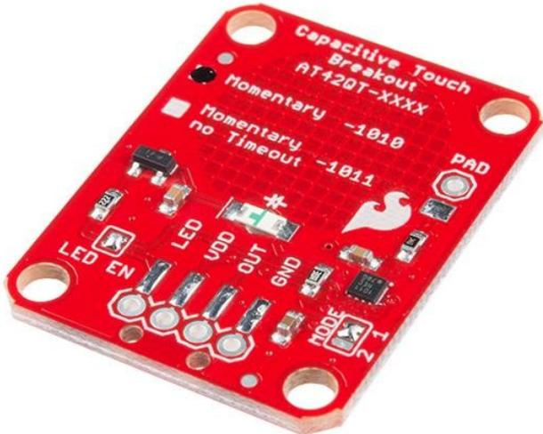
Wenn Sie Benutzereingaben hinzufügen möchten, ohne eine Taste zu verwenden, dann könnte eine kapazitive Touch-Schnittstelle die Antwort sein. Das AT42QT1010 SparkFun Capacitive Touch Breakout bietet eine einzelne, momentane kapazitive Touch-Taste mit einfach zu verwendenden digitalen I/O-Pins.
