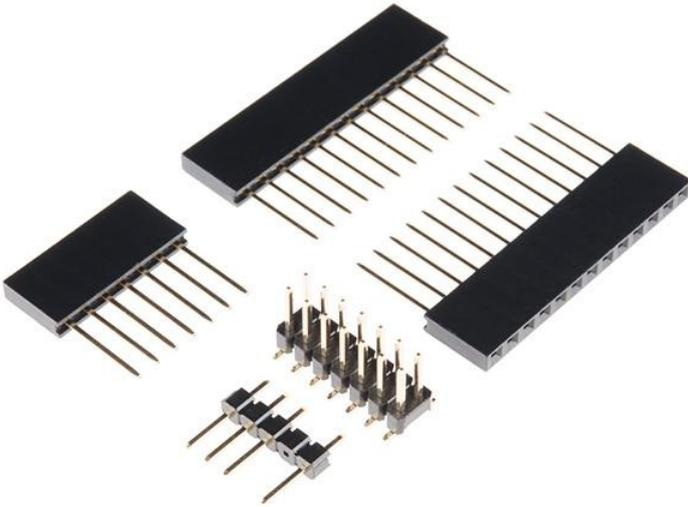
Diese Header sind für die Entwicklungsboards Teensy 4.0, Teensy 3.2 und Teensy LC geeignet. Jeder Satz von Steckverbindern macht Ihr Teensy-Breadboard kompatibel und ermöglicht das Stapeln eines Teensy und eines Teensy-kompatiblen Shield-Boards. Dieses Kit enthält fünf Stiftleisten (zwei 13-polige, eine 7-polige, eine 3-polige und eine 2x7 rechteckige SMT), genug, um Ihr gewähltes Teensy in jeder gewünschten Konfiguration anzuschließen!
