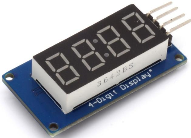
Auf diesem Board befinden sich ein Ziffernblatt mit vier LED-7-Segment-Anzeigen (mit Doppelpunkt an der zweiten Stelle für zB. Uhrzeiten), ein TM1637 Treiber-IC und 4 Pins zur Verbindung mit einem Mikrocontroller (Raspberry Pi, Arduino, ...)
