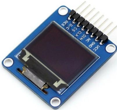
0.95" RGB OLED Display mit SPI Interface.
