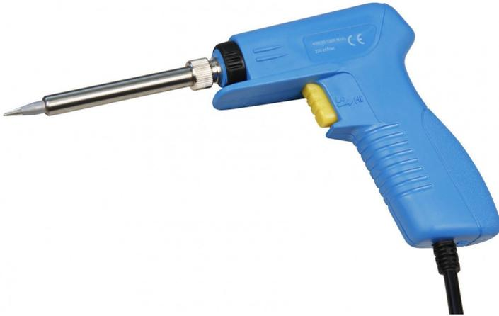
Durch Eindrücken des Abzugs kann die Heizleistung kurzfristig (ca. 30 Sek.) auf 130 Watt erhöht werden! Ausführung mit ergonomischem Griff. LötKolben zum Löten und Entlöten von elektrischen und elektronischen Komponenten bei gedruckten Schaltungen und Modulen, zum Verzinnen von Leiterbahnen und Kabelenden und Kabelverbindungen, sowie im Bereich der Hobbytechnik.
